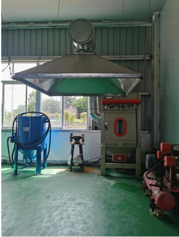
喷砂集气罩+布袋吸尘器
