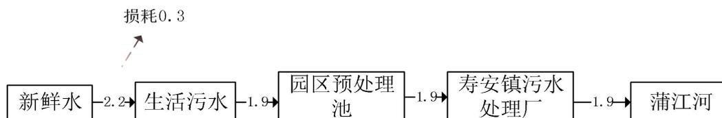
图 2-6 项目水平衡图 (m<sup>3</sup>/a)
